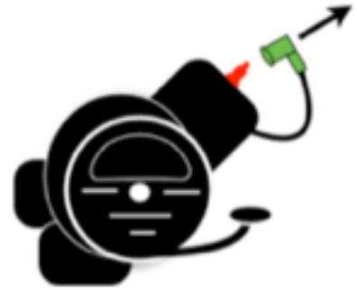
Du siehst ein abgedecktes Lüfterrad und obendrauf, etwa auf 2 Uhr einen Stecker. Den solltest du mit einem Ruck nach oben ziehen können.
